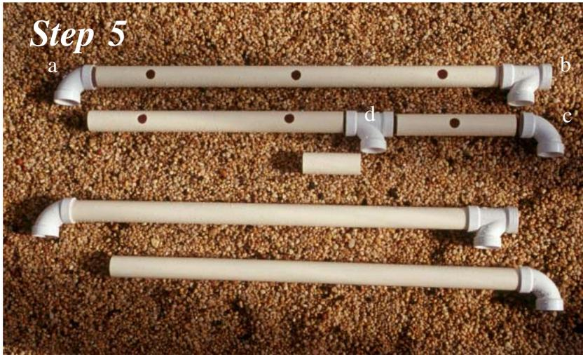
단계 5. 부품 목록에 따라 절단 및 드릴 된 배수 및 상단 레일을 배치합니다. 여기서 가장 위에있는 두 개의 파이프가 6 피트 배수 레일을 구성합니다. 반환 된 영양소 가스 탱드를 채우는 것을 방지하려면 양쪽 끝에있는 두 개의 'L'피팅과 6'스팬의 중간에 두 섹션을 함께 고정하는 단일 'T'피팅을 연결해야 합니다 (라벨 a, b, c.) 배수구 (d.)는 깨끗하고 깨끗해야 합니다.
