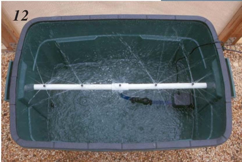
12 단계. 물을 채우고 시승을 위해 가져 가십시오. 스프레이 바의 회전을 조정하여 스프레이가 가능한 한 평평 해 지도록 합니다. Aerospring을 건조한 상태로 작동하지 마십시오. 펌프 상단은 영양소가 도달 할 수 있는 최저 수준이며, 낮은 수준은 펌프 고장을 일으킬 수 있습니다.
